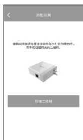
④ 将网关连接网络待指示灯变为绿色常亮时点击“扫描二维码”
